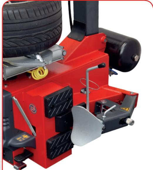
La particolare forma e la robustezza del braccio stallonatore garantiscono lo stallonamento rapido di tutte le tipologie di ruote.
