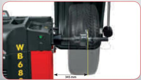
**Gruppo di lancio robusto e preciso:** tipico di un'equilibratrice top della gamma può operare su ruote di peso max. fino a 80 kg e con un offset interno fino a 345mm (distanza tra appoggio ruota e cassone) senza l'utilizzo di alcun distanziale. Questo facilita l'ispezione del cerchio/ruota e rende più veloce il posizionamento del peso sul lato interno.
