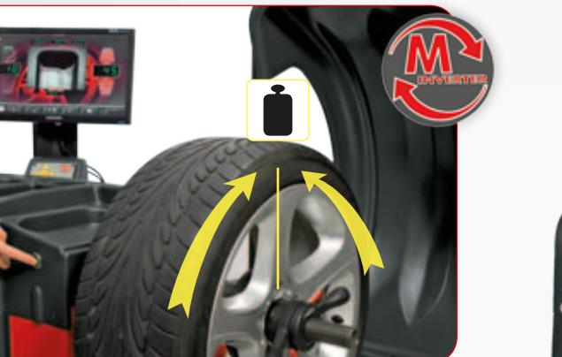
Sistema di lancio con Motor inverter: consente di lanciare e fermare la ruota in un tempo molto rapido (circa 7sec. con una ruota 15"x6) e con elevata silenziosità del gruppo meccanico. Pulsante di arresto in posizione "Stop on top": agevola l'applicazione del peso sul cerchio portando la ruota in posizione e mantenendola ferma (particolamente indicato con i programmi Aludata).
