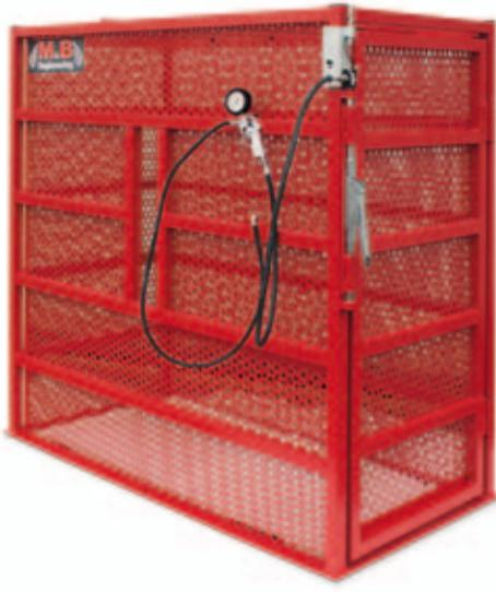
**La speciale struttura composta da barre in ferro e rete a forma di alveare rende la gabbia di gonfiaggio IC BOX estremamente sicura, poiché la pressione generata dall'eventuale esplosione del pneumatico viene contenuta dalla gabbia e la fuoriuscita di frammenti viene estremamente ridotta, limitando così al minimo i danni all'operatore.**
