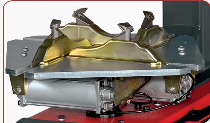
Le 4 griffe autocentranti sono controllate da due cilindri di diametro 80 mm dando al sistema una maggiore sicurezza di aggancio del cerchio. L'altezza del cuneo di presa dal piatto permette il bloccaggio di ruote di veicoli commerciali.
