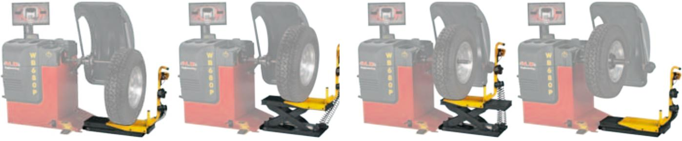
Sollevatore ruota ergonomico e funzionale, agevola l'operazione di carico e scarico delle ruote fino a un peso massimo di 80 kg, eliminando qualsiasi sforzo fisico da parte dell'operatore.
