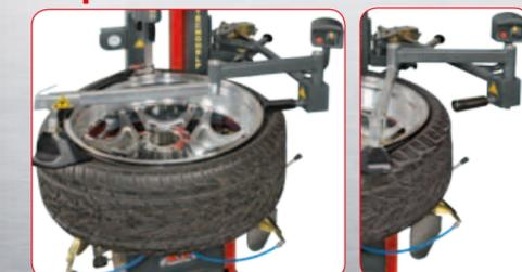
Dispositivo professionale indispensabile per operare su pneumatici a profilo largo e ribassato (UHP e Run Flat (RSC)) particolarmente duri e di grandi dimensioni. Struttura robusta progettata con 2 cilindri ad aria da 80mm che non subisce flessioni durante i difficili momenti di lavoro. Facilmente applicabile su tutte le macchine automatiche che sono già predisposte.
