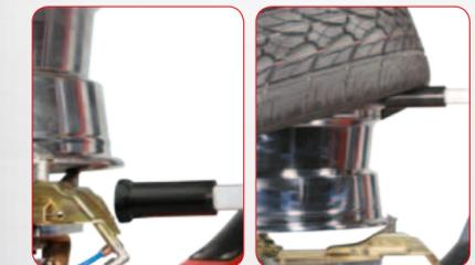
**Braccio con rullo con possibilità di operare al di sotto del pneumatico.**
